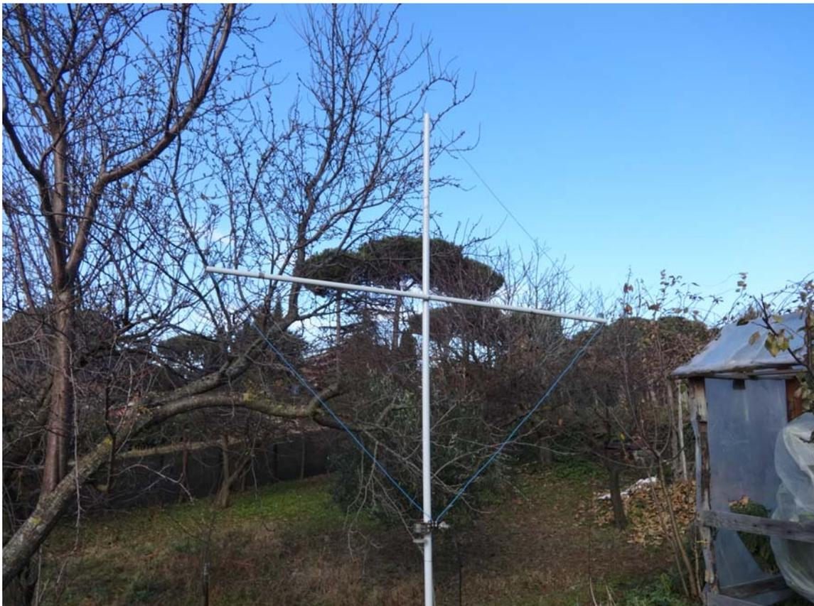
La costruzione è stata di una semplicità assoluta: tubi da impianti elettrici da 20 mm, fissati al centro tramite una vite da 5 MA, ma che potessero ruotare senza problemi, in modo da essere ripiegata e trasportata facilmente.
